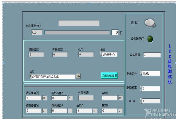
图 4 LCR 测试界面前面板
