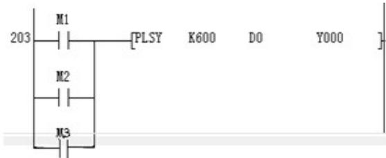
图 4 步进电机控制机械手梯形图
