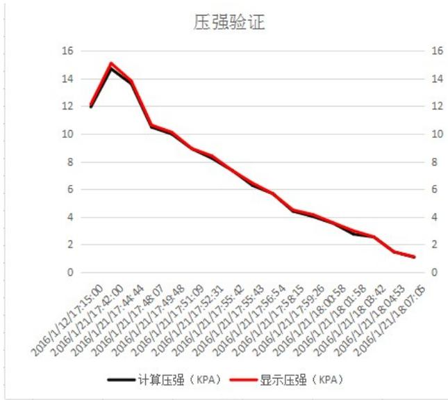
图 8 实际压强与显示压强数据对比折线图
