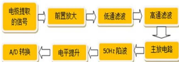
图 2 系统硬件设计原理框图
