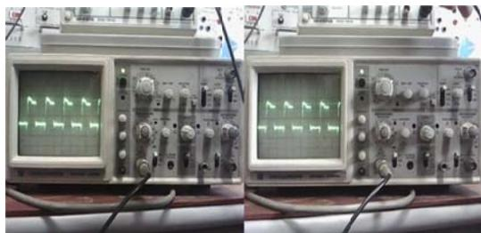
图 5 SG3525 电路 11 管脚和 14 管脚波形
