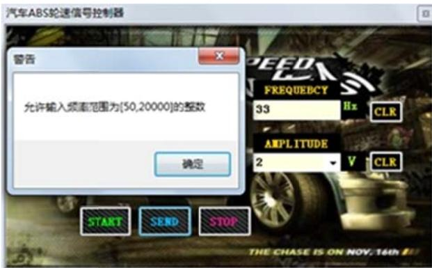
图 14 频率超出范围发送测试
