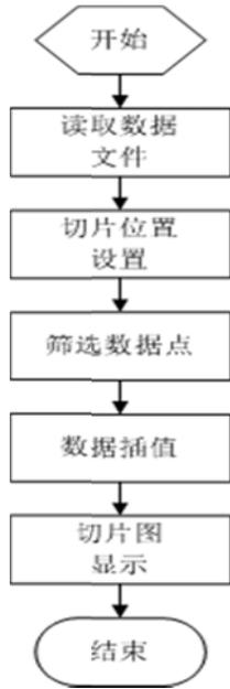
图 3 切片程序原理图
