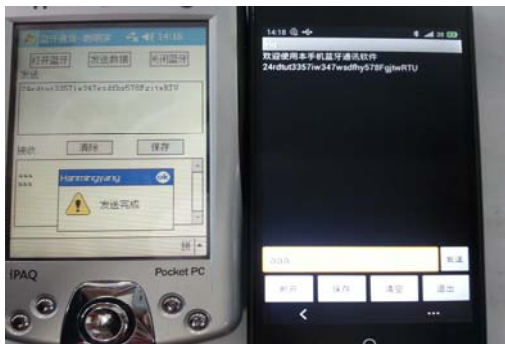
图 9 PDA 和手机端字符发送接收测试图
