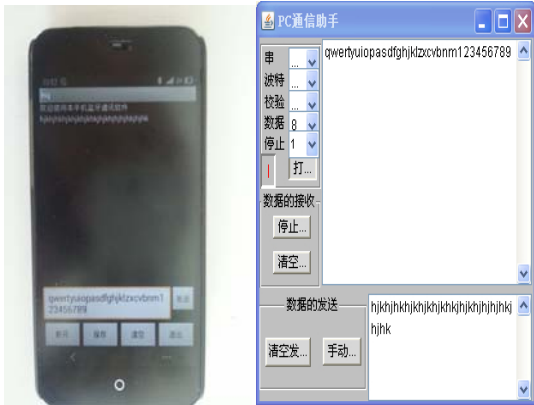
图 8 手机与 PC 端字符接收发送测试图
