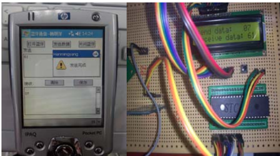
图 10 单片机与手机端接收与发送字符测试
